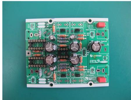
フィルムコンデンサ、IC ソケットなどを取り付けます。電解コンデンサには、極性がありますので注意してください。基板シルクの輪郭の太くなっている部分とコンデンサ本体の白帯を合わせて取り付けてください。IC ソケットは、切欠きの位置を合わせてください。
